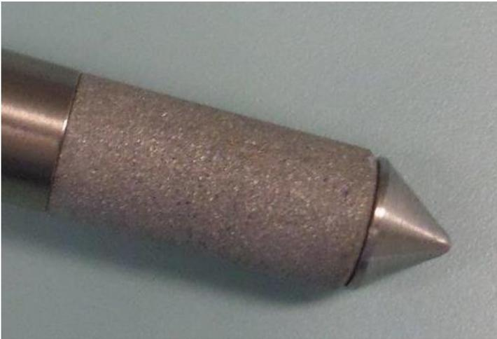
An der Sensorspitze befindet sich ein doppelter elektronischer T°- + rF-Sensor. Der Sensor ist durch einen feinen Edelstahlfilter geschützt. Die stumpfe Spitze sorgt dafür, dass der Sensor möglichst leicht in das Saatgut gesteckt werden kann, ohne das Saatgut zu beschädigen.
