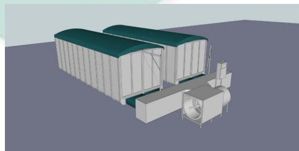
Stativ mit Messsensor für Luft aus den Containern. Unterschiedliche Anzahl von Containern je Abschnitt möglich
