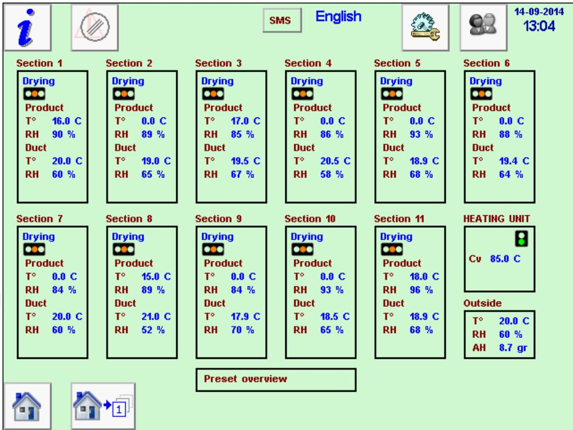
Touchscreen mit dem Umriss eines Trocknungsprogramm mit 11 Abschnitten. Für jeden Abschnitt ein rechteckiges Feld mit Basisinformationen über Trocknen; T ° und relative Luftfeuchtigkeit.
