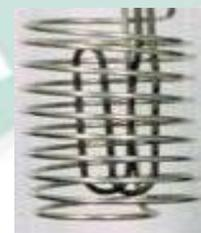
In Kombination mit einem elektrischen Heizelement wird die Wassertemperatur in der Säule genau geregelt.
